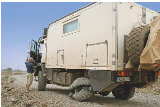
Éthiopie (à gauche) : hormis deux pneus totalement détruits, toutes les crevaisons ont pu être réparées.
